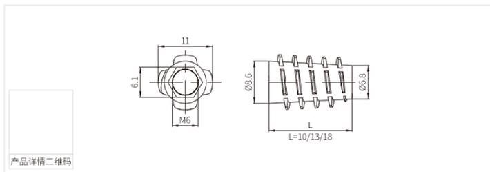
MK-ZA-52-00-08 锤头螺母 MK-ZA-52-00-08 Barrel nut
