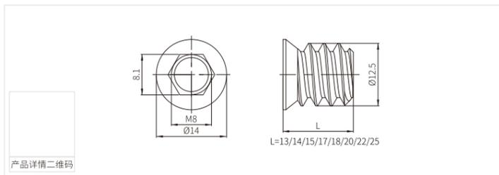
MK-CS-21-02-02 直通内外牙 MK-CS-21-02-02 Insert nut type E
