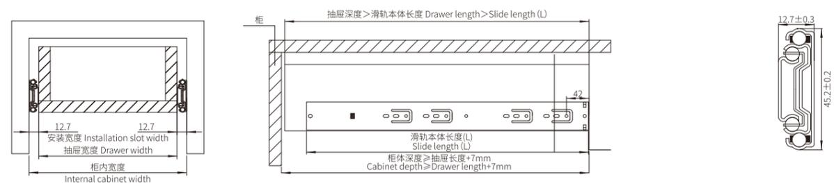
滑轨安装孔尺寸 Hole pattern
