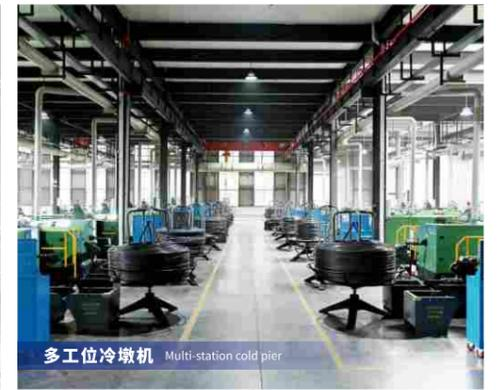
多工位冷墩机 Multi-station cold pier
