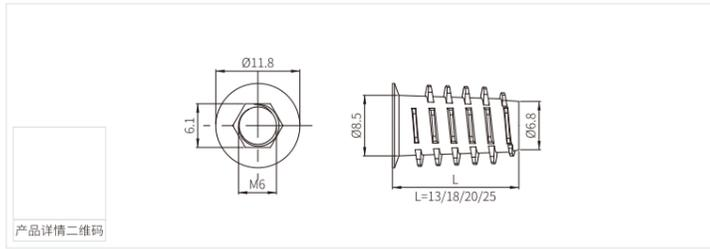
MK-ZA-51-86-18 无介内外牙螺母 MK-ZA-51-86-18 Insert nut type E
