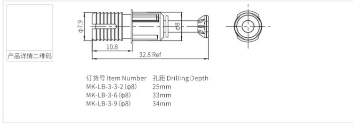
MK-LB-3-9 二合一拉爆杆 (φ10) MK-LB-3-9 Spreading bolt
