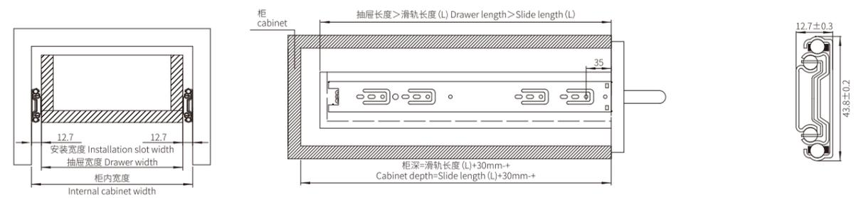
滑轨安装孔尺寸 Hole pattern
