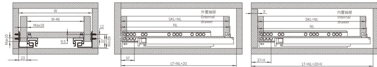
W=柜内宽度 SKL=抽屉长度 NL=滑轨标称长度 AL=滑轨实际长度 W=Internal cabinet width SKL=Drawer length NL=Nominal length of slide
