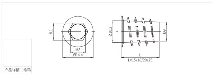
MK-ZA-52-00-14 锤头螺母 MK-ZA-52-00-14 Barrel nut
