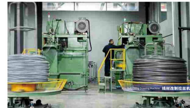
Wire Reforming Drawing Machine 线材改制拉丝机
