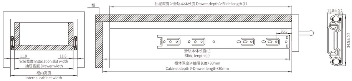
滑轨安装尺寸 Installation size
