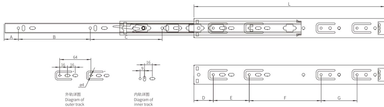
滑轨安装孔尺寸 Hole pattern
