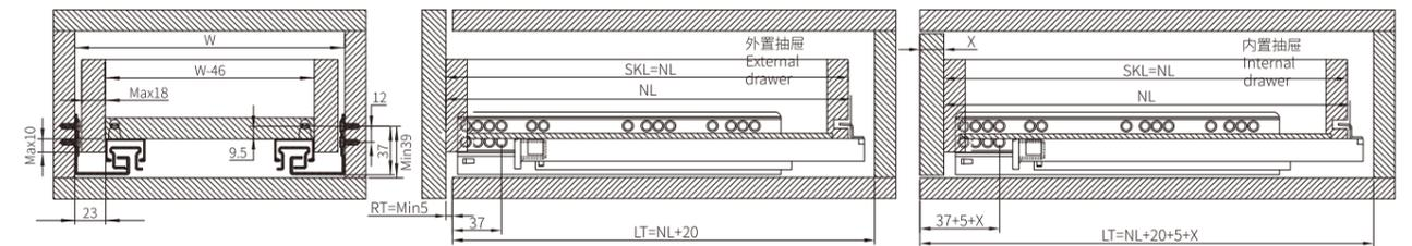
W=柜内宽度 SKL=抽屉长度 NL=滑轨标称长度 AL=滑轨实际长度 W=Internal cabinet width SKL=Drawer length NL=Nominal length of slide
